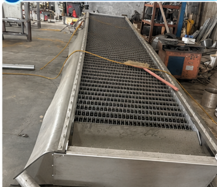
Máy cào rác hoàn thiện trước khi lắp đặt
