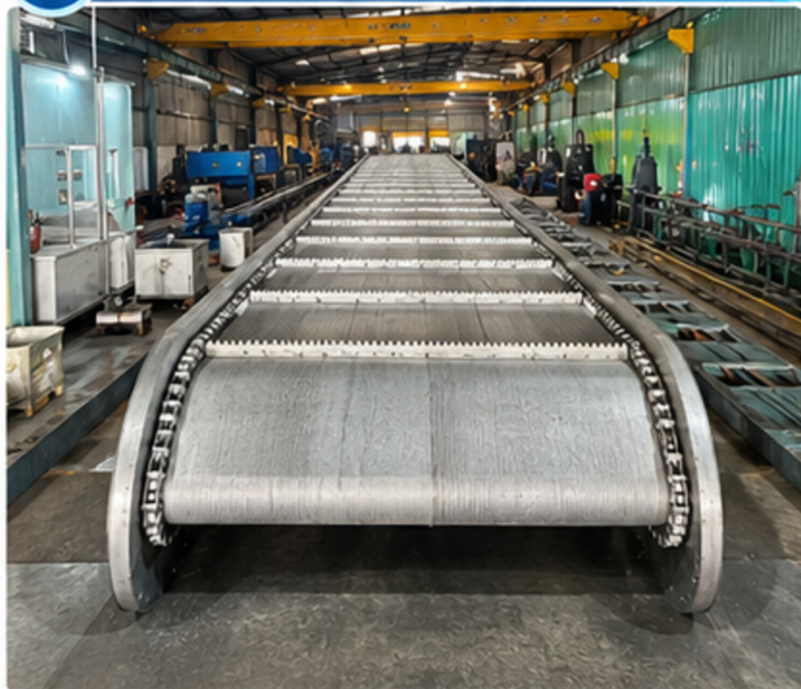
Cụm máy cào rác kích thước lớn đang chế tạo tại xưởng
