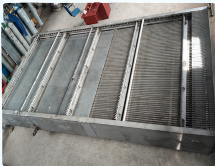
Chi tiết cụm lược rác trước khi lắp đặt
